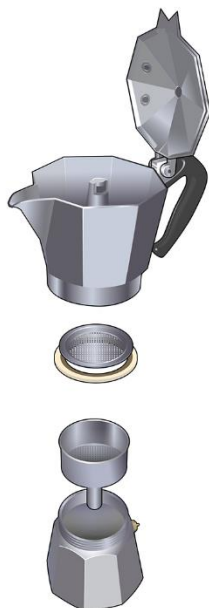
Exemplo de representação da vista explodida
